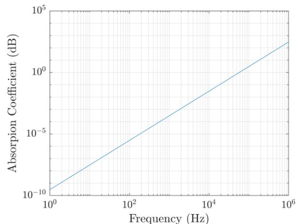
FIGURE 3: ATMOSPHERIC ATTENUATION COEFFICIENTS ( $T=540^\circ\text{C}$ ,  $p=101325$  Pa,  $RH=70\%$ ,  $L=1.0$  5m)
